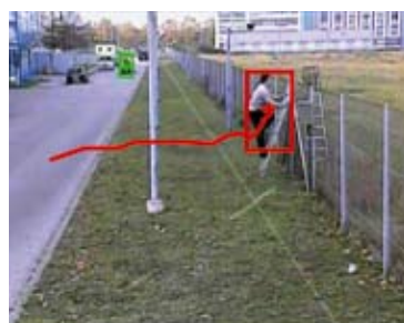
La personne franchit la ligne tendue près de la barrière et déclenche une alarme
